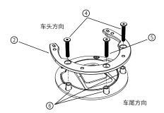
3. 将零件①放置在零件②上方(注意将孔位对齐),放入螺丝,并依次紧固螺丝。 (扭力: 1.5N·m)
